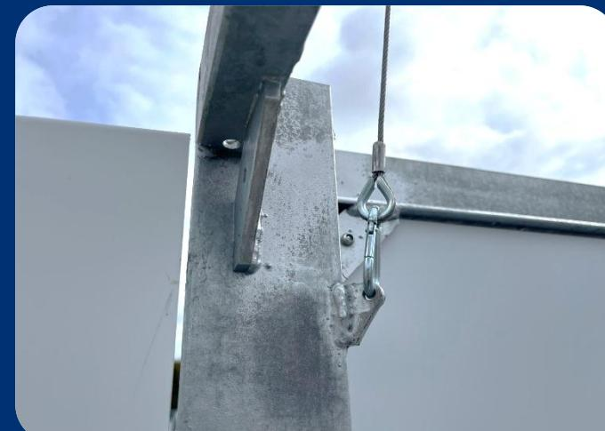
7. Bevor der Mast vollständig ausgefahren ist, überprüfen Sie die Haken erneut, um sicherzustellen, dass sie noch fest sitzen.
