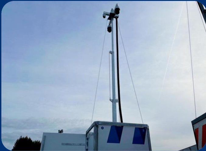
8. Déployez complètement le mât jusqu'à ce que les haubans soient tendus. Remarque : ne le tournez pas avec une force excessive !
