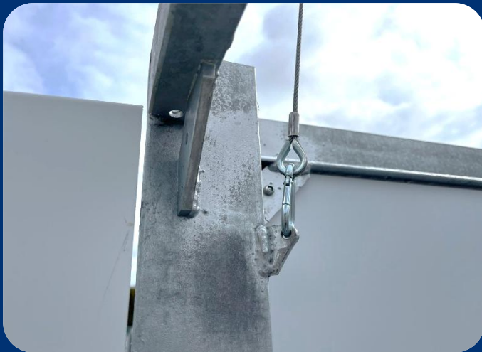
7. Avant que le mât ne soit complètement déployé, vérifiez à nouveau les crochets pour vous assurer qu'ils sont toujours bien fixés.
