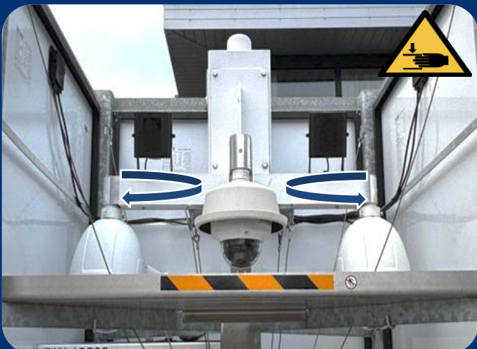
4. Tournez les lumières infrarouges dans la direction des angles de vision à surveiller.
