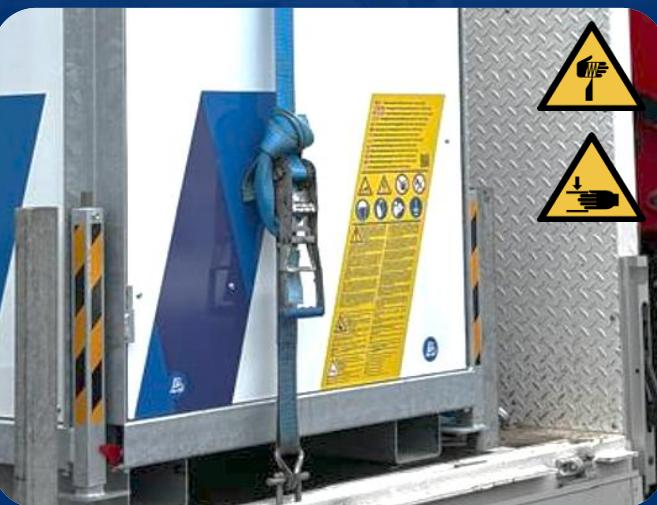
6. Befestigen Sie die überschüssige Länge des Zurrzugs.
