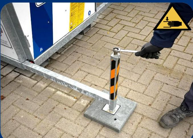
3. Ziehen Sie die Stützbeine vollständig heraus und legen Sie eine Stützplatte darunter. Lösen Sie die Beine mit dem 19-mm-Schraubenschlüssel. Verwenden Sie diesen, um den Turm auszurichten.
