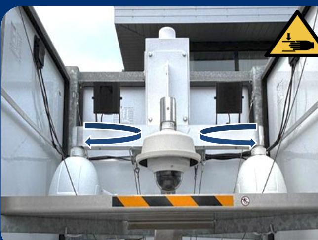
4. Drehen Sie die Infrarotstrahler in Richtung der zu überwachenden Blickwinkel.
