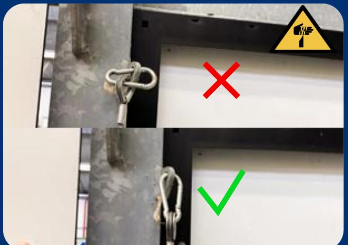
3. Antes de elevar el mástil, compruebe que los ganchos de los cables de sujeción se pueden mover libremente en el orificio.
