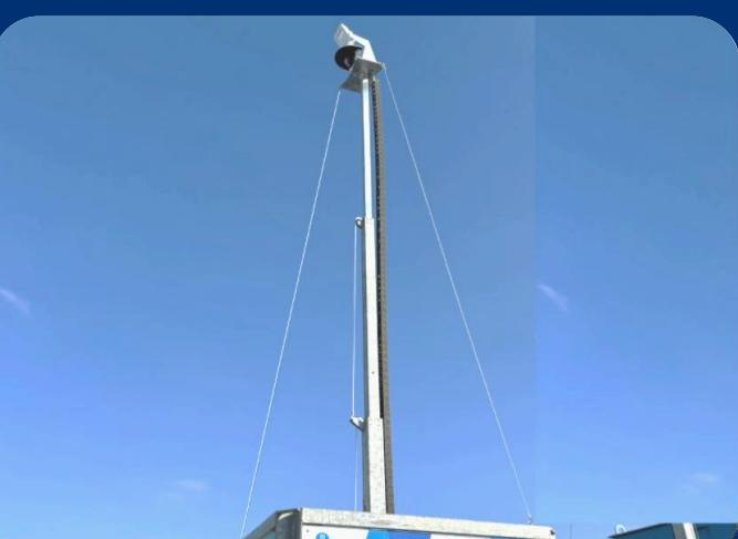
6. Extienda el mástil completamente hasta que los cables de sujeción estén tensos. Nota: ¡no lo gire con fuerza excesiva!
