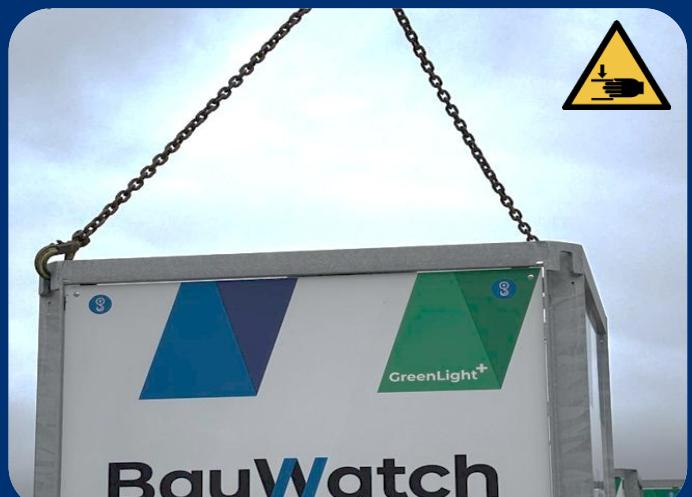
3. Utilice una cadena de elevación homologada (mínimo 2 ramales) en forma de cruz paraizar la torre. Utilice las argollas de elevación.
