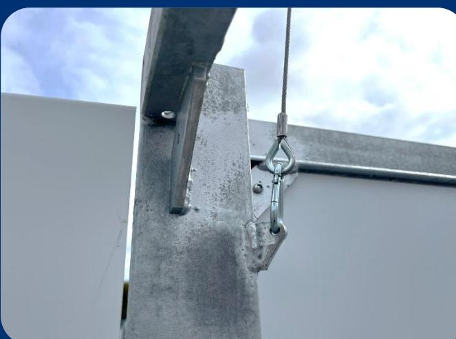
6. Bevor der Mast vollständig ausgefahren ist, überprüfen Sie die Haken erneut, um sicherzustellen, dass sie noch fest sitzen.
