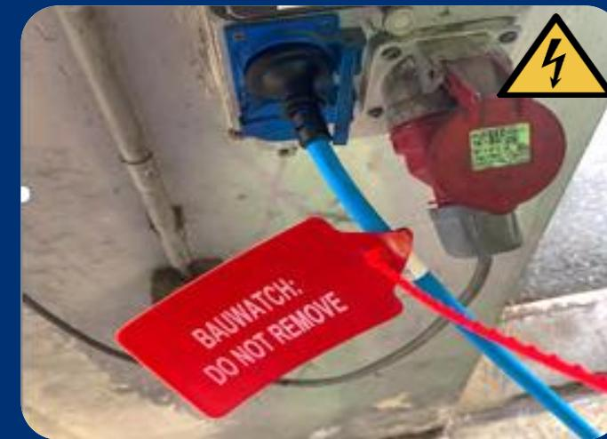
8. Verlängerungskabel unter dem Rahmen anschließen, im Batteriekasten verstauen. Kabel einführen und Abdeckung schließen.
