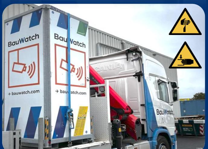
5. Fissare la torre utilizzando una cinghia di fissaggio, avendo cura di garantire che il telaio non si pieghi.
