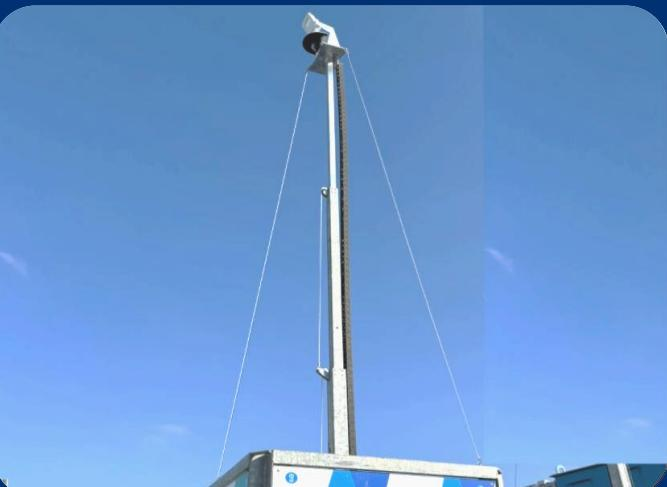
6. Estendere completamente il palo fino a quando i tiranti non sono tesi. **Attenzione:** non ruotarlo con forza eccessiva!
