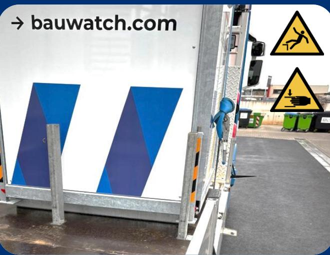
4. Coloque las estacas para evitar que se deslice.
