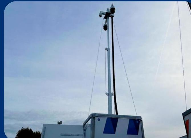
7. Extienda el mástil completamente hasta que los cables de sujeción estén tensos. **Nota:** ¡no lo gire con fuerza excesiva!
