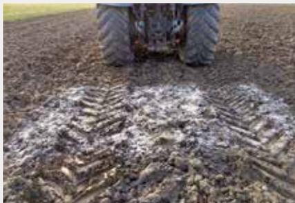
Überrollprobe auf einer mit Mehl bestäubten Bodenoberfläche: Der Reifeninnendruck beträgt 0,5 bar im linken und 1,9 bar im rechten Reifen.
