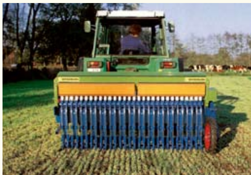
Die Drillsämaschine eignet sich für ebenes Gelände. In feuchtem Boden verstopft und verschmiert sie weniger als die Streifenfrässaatmaschine.
