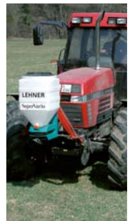
In Kombination mit Striegel und Walze eignen sich Schneckenkornstreuer sehr gut für die Übersaat.
