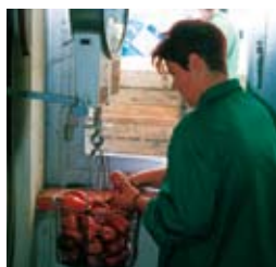
Der Stärkegehalt wird aus dem Unterwassergewicht errechnet.
