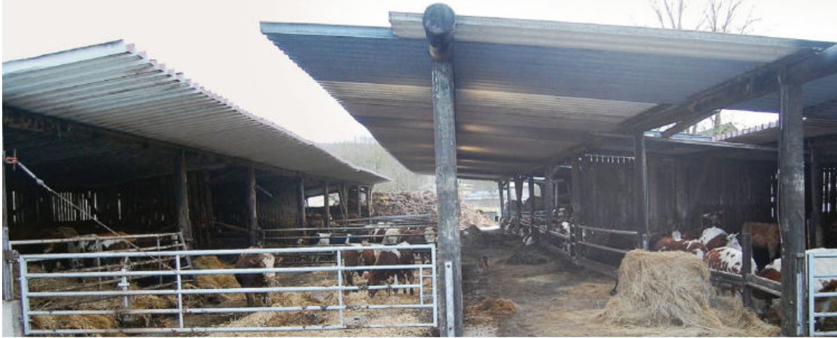
Der Tretmiststall für die Mastbullen wurde 2006 in einfacher Rundholzbauweise mit Pulldächern erstellt.
