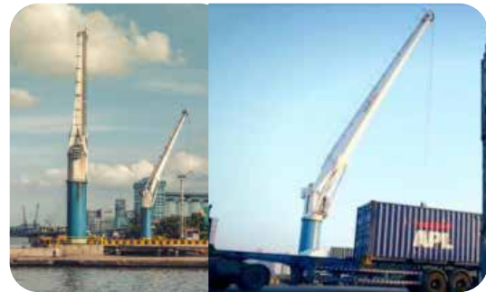
ข.) เครนยกตู้คอนเทนเนอร์บริเวณหน้าท่า แบบหมุน (Jib Crane)
