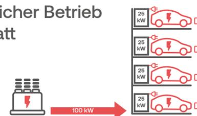
**Ohne Speicher:** Schnellladestationen benötigen leistungsstarke Netzanschlüsse – teuer in der Installation und oft mit hohen Leistungsentgelten verbunden.
