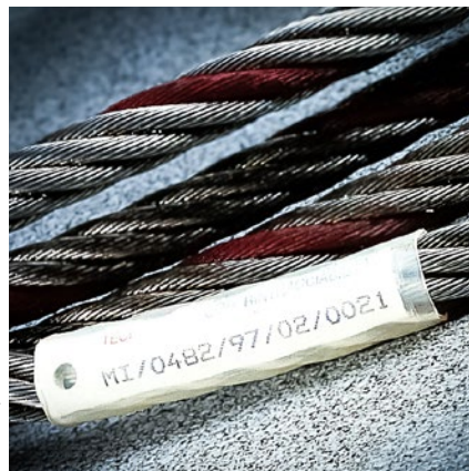
Esempio di marcatura di una corda TECI con un codice tracciabile MI/0482/97/02/0021.
