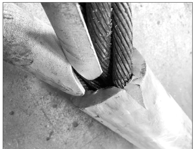
Abb.: Riss im Verpressbereich einer Aluminium-Pressklemme
