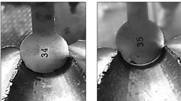
Abb.: Reduzierter Rillendurchmesser auf Trommel
