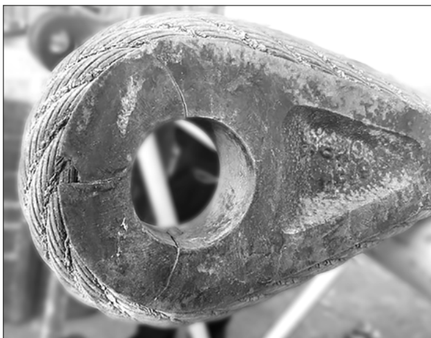
Abb.: Risse in einer Vollkausche
