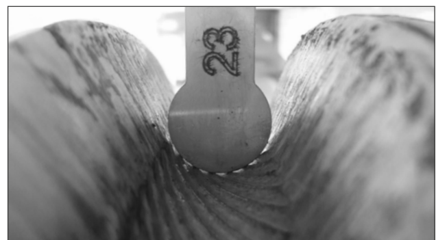
Abb.: Deutliche Abdrücke eines Seilnegativprofils
