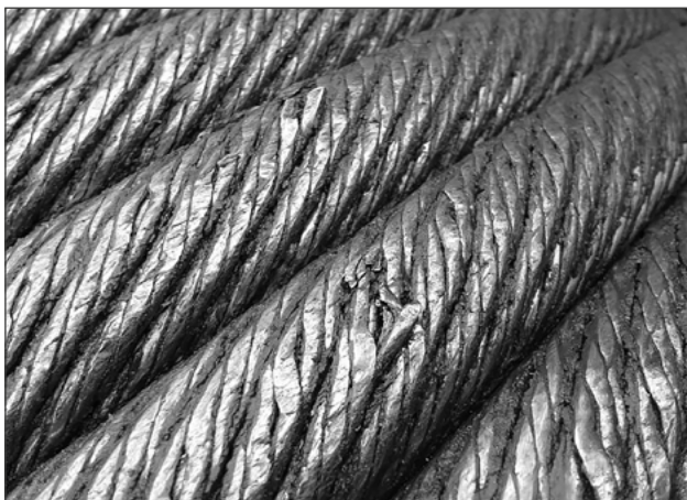
Abb.: Verschleiß in der Mehrlagenwicklung
