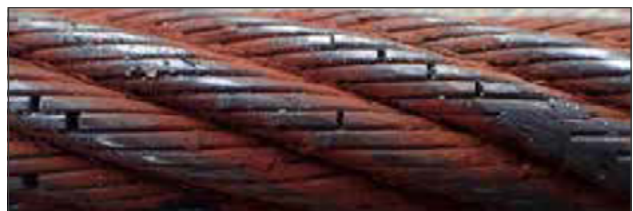
Abb.: Innere Korrosion - 100 % Ablegereife
