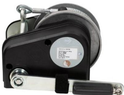
L'IKLW 300 è un argano a manovella per il trasporto di materiali. Permette di trasportare carichi fino a 500 kg. L'argano viene utilizzato in combinazione con i treppiedi e i bracci di estensione omologati a tale scopo. Serve per il trasporto sicuro e fluido di materiali in profondità e per estrarli fuori. La manovella è dotata di un freno automatico a pressione e si blocca immediatamente se la manovella viene rilasciata.
