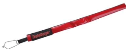
Il proteggifune protegge la fune dalle superfici abrasive. È composto da un materiale telato resistente con una chiusura lampo per tutta la lunghezza. Per fissarlo, il proteggifune viene fissato alla fune con un punto metallico. Il proteggifune è adatto per funi con un diametro fino a 16mm..
