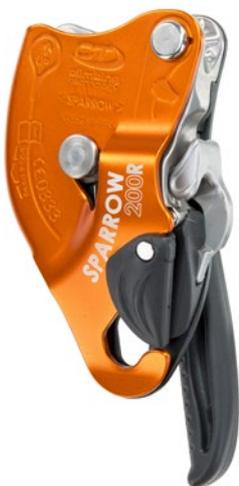
**Certificazione:** EN 341:2011/2A con Patron 11 mm + 11 Patron Plus omologato, EN 12841 modello C, carichi Max. nominali secondo EN 341: 200 kg, carico nominale max. secondo EN 12841: 210 kg
