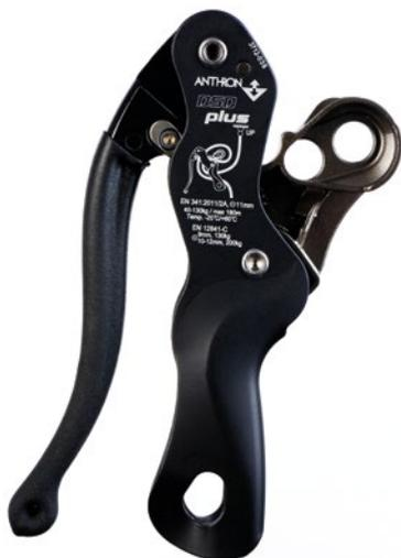
**Certificazione:** EN 341:2011/2A con PATRON 11 mm omologato, EN 12841 modello C, carichi nominali secondo EN 341: da 30 a 60 kg, carico nominale max. secondo EN 12841: 200 kg (diametro fune 10-12 mm) e 130 kg (diametro fune 9 mm)
