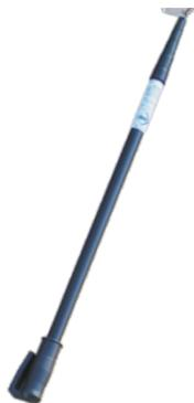
Asta telescopica in alluminio estraibile fino a 3,60 m con supporto con moschettone montato all'estremità della testa, utilizzabile soltanto in combinazione con un moschettone Attack in alluminio. La lunghezza inserita è pari a ca. 80 cm con un peso di soli 510 g. Appositamente sviluppato per il fissaggio della fune di salvataggio del discensore ABS 3a e ABS 4 alla persona vittima di incidente.
