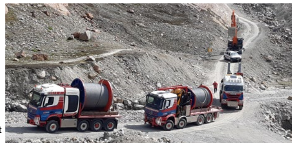
Schwertransport eines Stahlseils.
