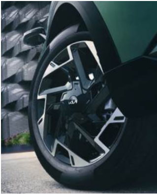
19" lichtmetalen velgen met 235/50 banden - Standaard op GT Line benzine, diesel en PHEV
