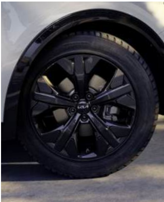
19" lichtmetalen velgen met 235/50 banden - Standaard op Style Edition benzine, diesel en PHEV
