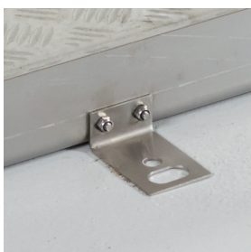
Pattes de scellement pour la fixation à l'aide de chevilles d'ancrage à percussion M10. Le cadre se compose exclusivement d'acier inoxydable.
