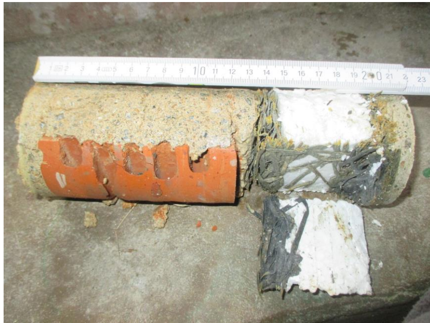
Foto 9: Wandaufbau Kühlraum, Lager
