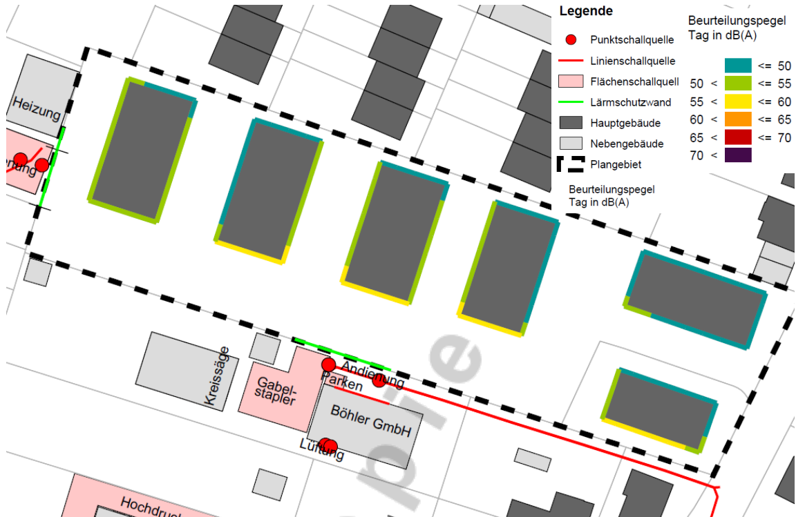
Abbildung 8: Beurteilungspegel Gewerbelärm - 3. Obergeschoss am Tag
