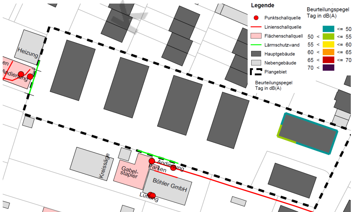
Abbildung 8: Beurteilungspegel Gewerbelärm - Erdgeschoss in der Nacht
