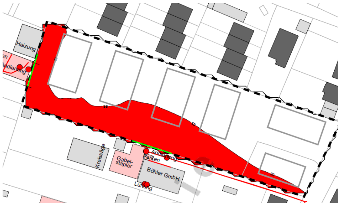
Abbildung 3: Ausschluss schutzbedürftiger Räume im 2. Obergeschoss - Beurteilungspegel Tag in dB(A); über 55dB(A) in Rot dargestellt.
