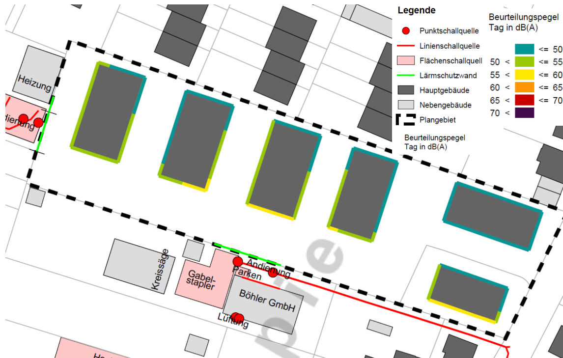
Abbildung 6: Beurteilungspegel Gewerbelärm - 1. Obergeschoss am Tag
