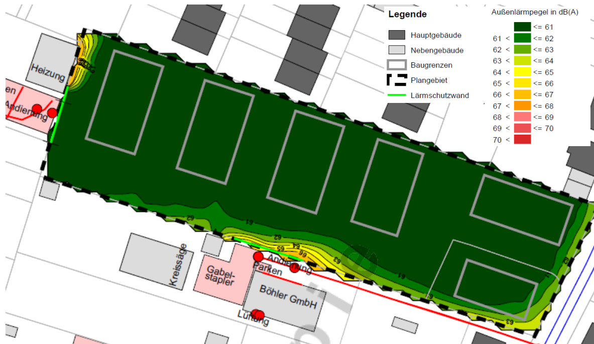
Abbildung 16: Verkehrslärm - Außenlärmpegel im Erdgeschoss am Tag
