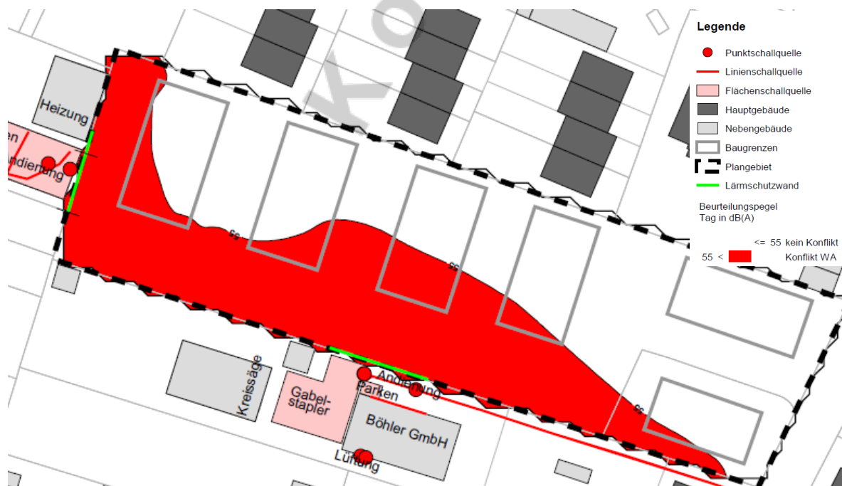
Abbildung 3: Ausschluss schutzbedürftiger Räume im 2. Obergeschoss - Beurteilungspegel Tag in dB(A); über 55dB(A) in Rot dargestellt.
