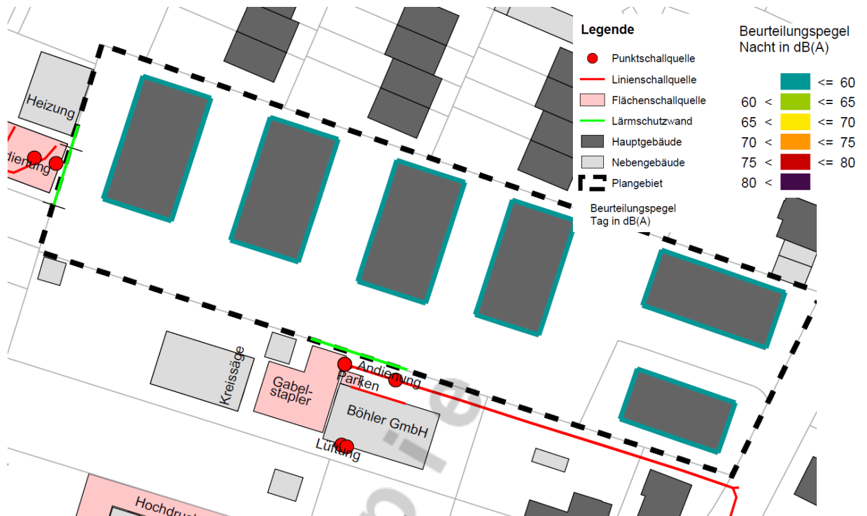
Abbildung 13: Beurteilungspegel Gewerbelärm – Maximalpegel (selten) im 1. Obergeschoss in der Nacht
