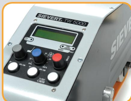
**Pannello di controllo molto facile da utilizzare. Display digitale che mostra temperatura, velocità e voltaggio.**
