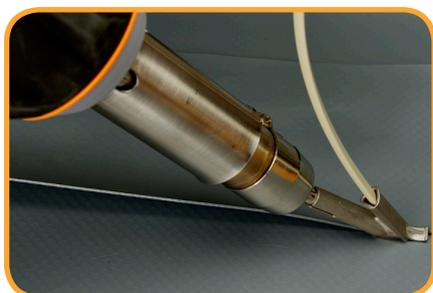
Saldatrice ad aria calda manuale
