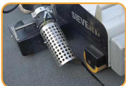
Saldatrice ad aria calda automatica
