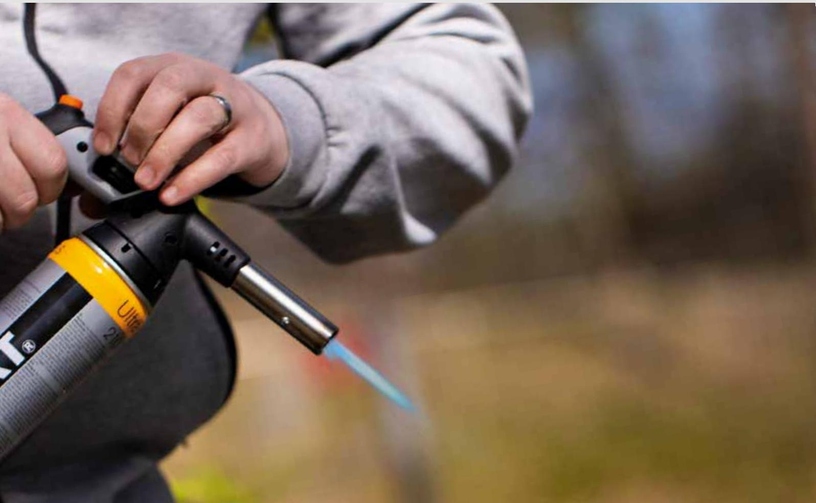
Multifunktionalität ist das Schlüsselwort für die Handyjet Lötlampen Linie. Diese Lötlampen können für eine Reihe von Tätigkeiten eingesetzt werden. Hierzu zählen zum Beispiel Weich- und Hartlötarbeiten im Sanitär-, Heizungs- und Klimabereich, allgemeine Anwärmarbeiten, sowie Farbentfernung.
