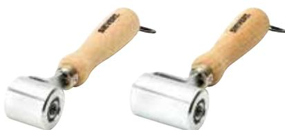
Stahl-Andrückrollen, kugelgelagert für hohen Anpressdruck zur Verschweißung im Überlapp Verfahren von bituminösen Dach- und Dichtungsbahnen. Der ergonomisch geformte Handgriff bietet optimale Handhabung und Dosierung des Anpressdrucks.
