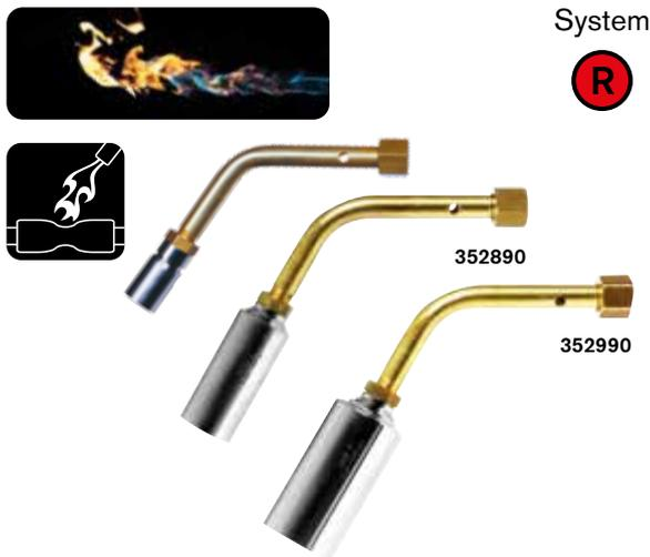
Diese Brenner haben eine weiche, kraftvolle Flamme mit einem Gelbstich, welche auch bei Tageslicht sichtbar ist. Hierdurch wird ein Überhitzen des Schrumpfmateri als verhindert. Der optimale Arbeitsdruck beträgt 2 bar.
