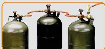
Durch Anschluss dieses Adapters können, in Verbindung mit dem Schlauchstück 770082, zwei oder mehr 5, 11 oder 33 kg Gasflaschen zu einer sogenannten Mehrflaschenanlage verbunden werden. Je zusätzlich angeschlossener Gasflasche wird jeweils ein Stück 770067 und ein Stück 770082 benötigt.
