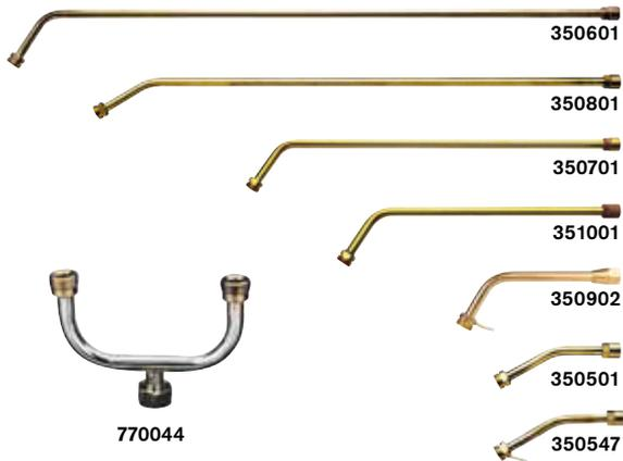
Alle Sievert Brenner passen auf diese Halsrohre. Halsrohr 350902 sind zusätzlich mit einem Aufhängehaken ausgestattet. Kurze Halsrohre wie 350501, 350547 und 350902 sind für kleine Brenner (z.B. für Lötarbeiten) geeignet. Die langen Halsrohre 350601, 350701, 350801 und 351001 sind für größere Aufgaben (z. B. Dacharbeiten und Straßenbau) konzipiert. 770044 Zweifach Gabelstück ermöglicht den Anschluss von zwei Brennern an einem Halsrohr.
