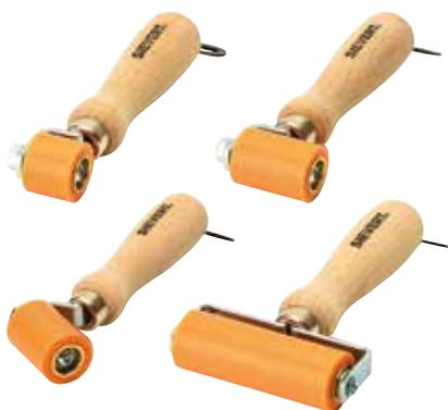
Silikon-Andrückrolle, kugelgelagert zur Verschweißung im Überlapp Verfahren von thermoplastischen Dach- und Dichtungsbahnen. Der ergonomisch geformte Handgriff bietet optimale Handhabung und Dosierung des Anpressdrucks.
