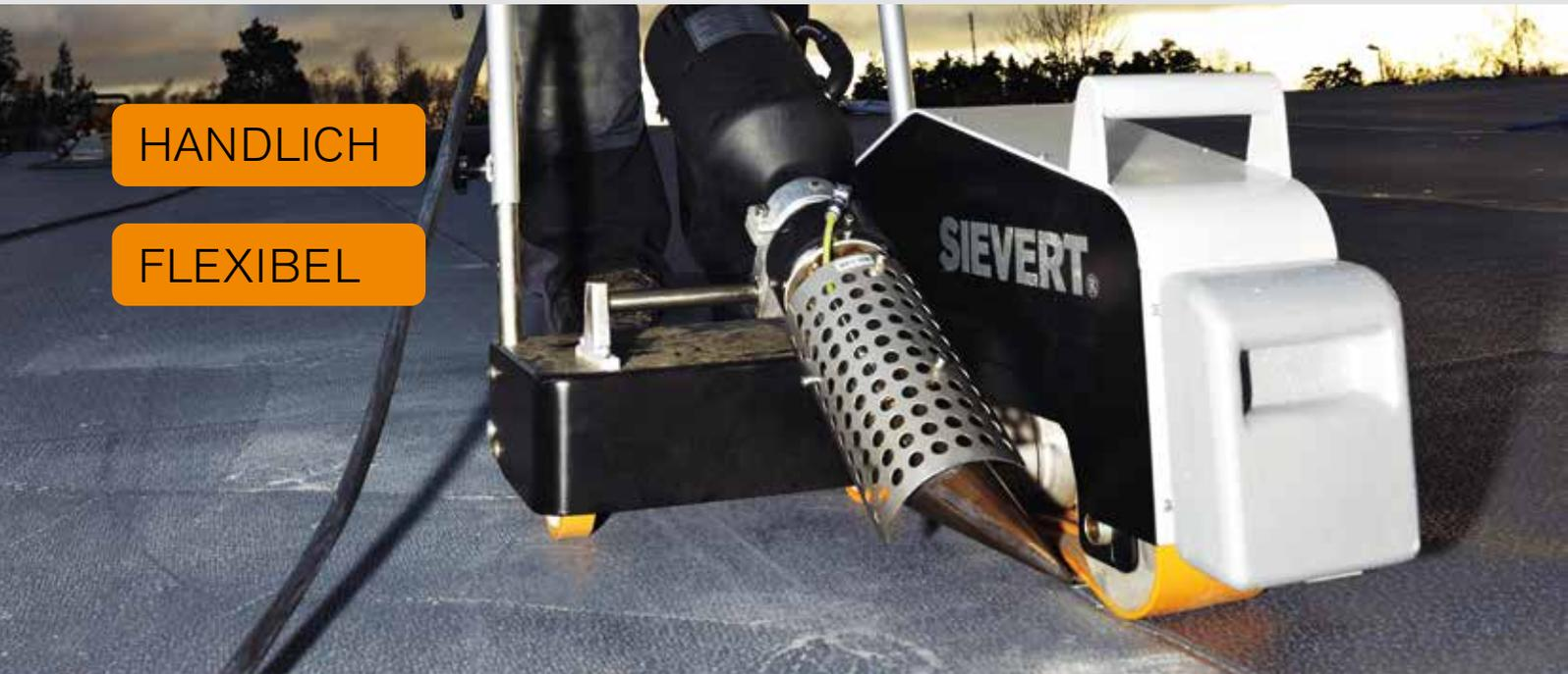
Der Sievert TW 5000 ist ein Heißluft-Schweißautomat und wurde in Zusammenarbeit mit erfahrenen Technikern für Dach- und Dichtungsbahnen entwickelt. Heraus kam ein universeller Schweißautomat zur Nahtverschweißung von Dach- und Dichtungsbahnen, wie PVC, ECB, EVA, EPDM, CSPE, TPO und alle anderen Bahnen, welche im Überlapp-Verfahren geschweißt werden können.
