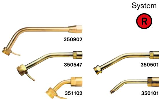
Alle Sievert Brenner passen auf diese Halsrohre ausgenommen Brenner 8842 – hier kann nur das Halsrohr 3501 verwendet werden. Halsrohr 3509 und 3511 sind zusätzlich mit einem Aufhängehaken ausgestattet. Alle hier gezeigten Halsrohre verfügen handgriffseitig über einen 3/8" LI Gewindeanschluss.
