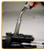
Heißluftbrenner zum Aufschmelzen von Plastikmaterial, Farbabbrennen sowie für alle Arbeiten wo eine offene Flamme Materialschäden verursacht. Der optimale Arbeitsdruck beträgt 2 bar.
