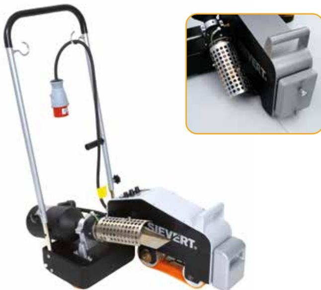
Das Modell 2990 kommt mit Silikon-Antriebsriemen und 50 mm Schweißdüse und eignet sich insbesondere zur Verschweißung von allen thermoplastischen Dach- und Dichtungsbahnen.
