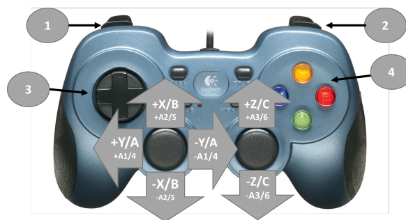
Abbildung 9: Tastenbelegung des Gamepads
