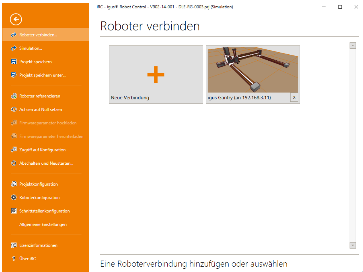
Abbildung 5: Hinzufügen oder Wählen einer Verbindung zu einem realen Roboter
