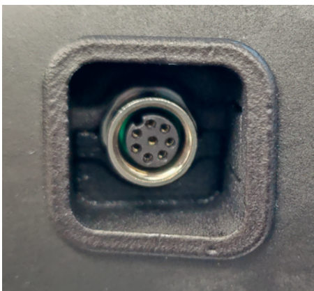
Abbildung 35: 8-polige DIO-Buchse am Roboterarm
