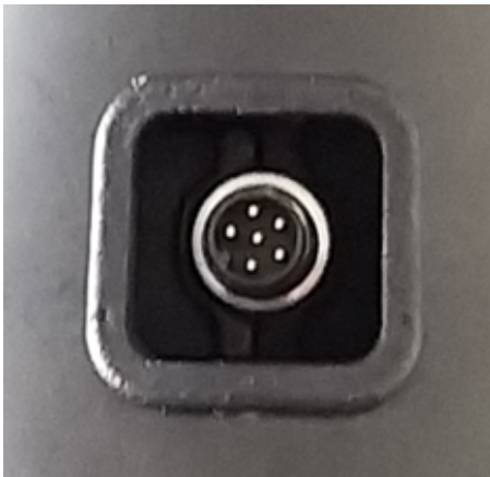
Abbildung 37: 6-polige DIO-Buchse am Roboterarm
