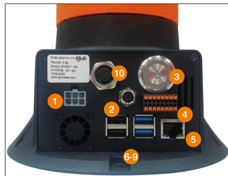
Bild 1: Basis-Anschlüsse des ReBeL® (mit Nummerierungs-Beispiel)
