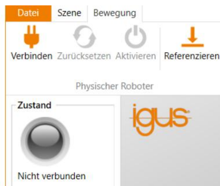
Bild 28 Schaltflächen für die Verbindung mit der Hardware, das Zurücksetzen von Fehlern und die Aktivierung der Motoren, die Referenzierung und "Status"-Anzeige
