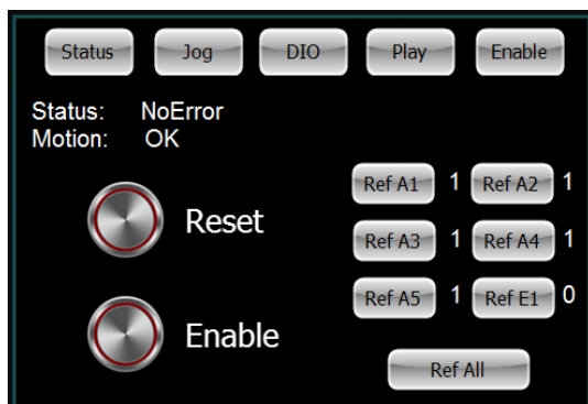
Abbildung 27: Drücken Sie nun nochmals den runden Knopf "Reset", gefolgt von dem runden Knopf "Enable". Der Roboter ist nun referenziert. Linearbewegungen und Programmen können nun abgefahren werden.
