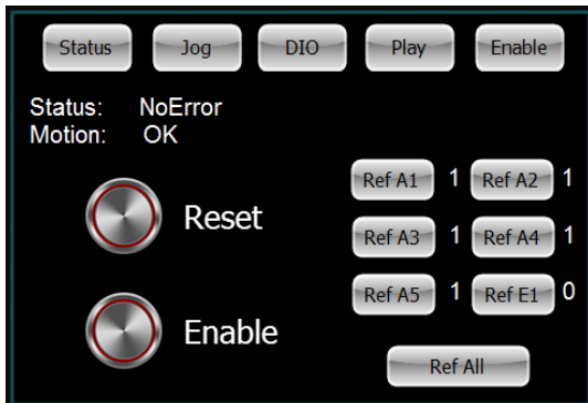
Abbildung 28: Drücken Sie dazu die Taste "Play" am oberen Rand des Displays und wählen Sie mit den Tasten "prev" und "next" ein Programm auszuwählen, das für Ihren Roboter geschrieben wurde.
