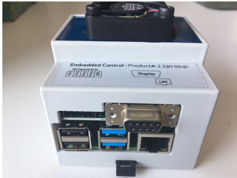
Abbildung 11: LAN- und Display-Anschluss. Die USB Anschlüsse bleiben ungenutzt.
