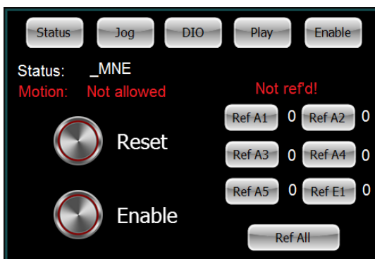
Abbildung 23: Drücken Sie jetzt "Reset": Der Status wechselt zu "MNE" (Motor Not Enabled)
