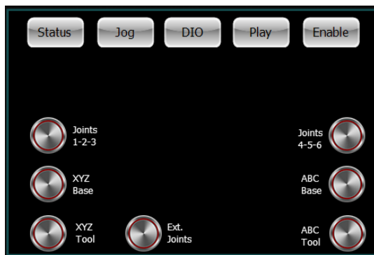
Abbildung 25: 1. Drücken Sie dazu die Taste "Jog" oben auf dem Display. 2. Drücken Sie "Joints 1-2-3". Dann bewegen und drehen Sie den Joystick. Sie können nun die Achsen 1, 2 und 3 bewegen. 3. Drücken Sie "Joints 4-5-6". Bewegen Sie nun die Achsen 4 und 5 durch Bewegen und Drehen des Joysticks.
