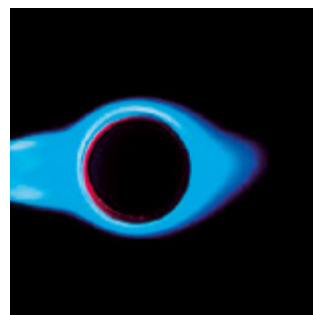
Hohe Flammentemperatur durch Zyklonverwirbelung
