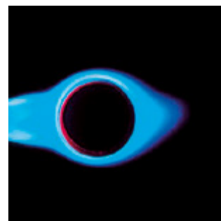
Hohe Flammentemperatur durch Zyklonverwirbelung
