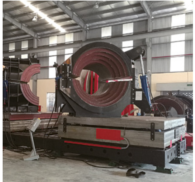
Manuelle Werkstattmaschine mit Werkzeug und Reduzierungen
