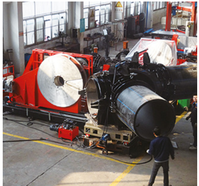
Herstellen eines Y-Stücks auf einer Werkstattmaschine
