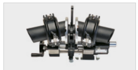
Durch beidseitige Gradeinstellung der Grundspannelemente (15° je Seite) können Segmentbögen hergestellt werden
