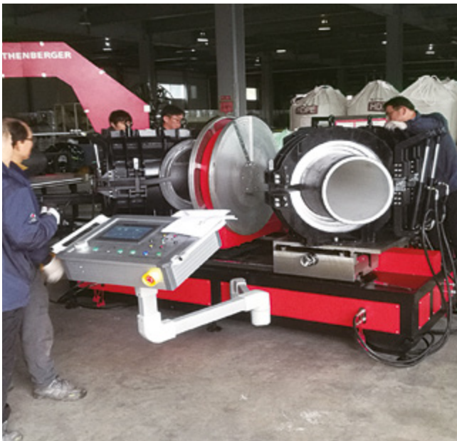
Herstellen eines Winkels mit einer CNC-gesteuerten CNC Maschine
