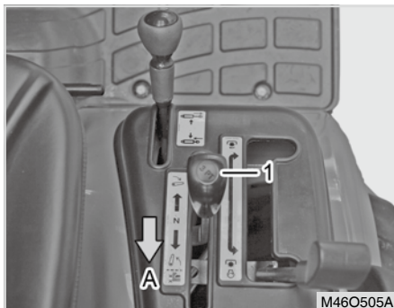
(1) Positionskontrollhebel (A) Heben
