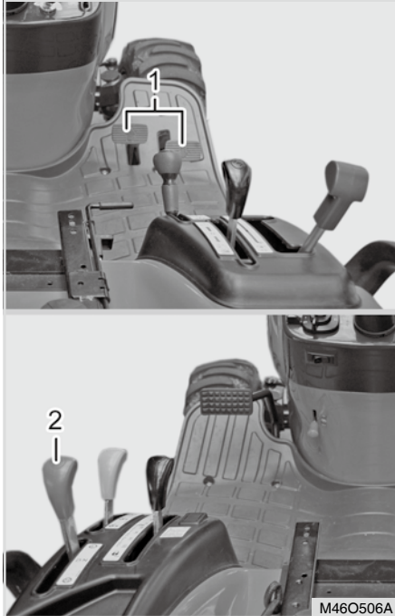
(1) Pedale für Vorwärts-/Rückwärtsfahrtrichtung (2) Bereiche Schalthebel
