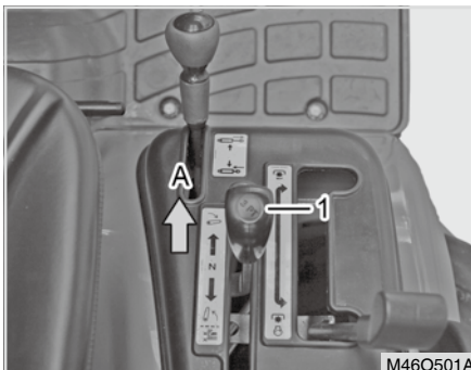
(1) Positionskontrollhebel (A) HERUNTER
