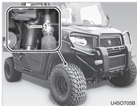
(1) Schmiernippel (Antriebswelle vorne im Bereich des Zahnradkastens)
