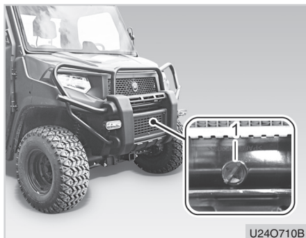
(1) Kühlflüssigkeit-Ablaßschraube des Kühlers
