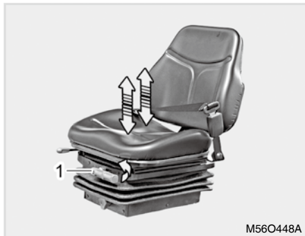
(1) Hebel für Anpassung der Polsterung
