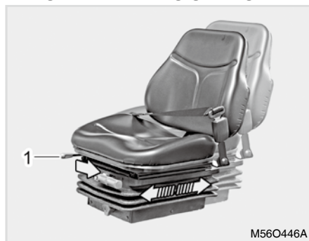
(1) Einstellhebel für rückenlehne
