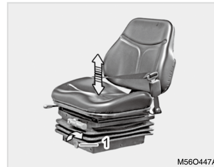
(1) Hebel für einstellung der sitzhöhe
