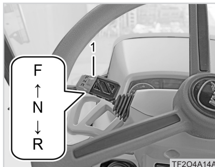
(1) Wendegetriebe-Schalthebel (F) Vorwärts (N) Neutral (R) Rückwärts
