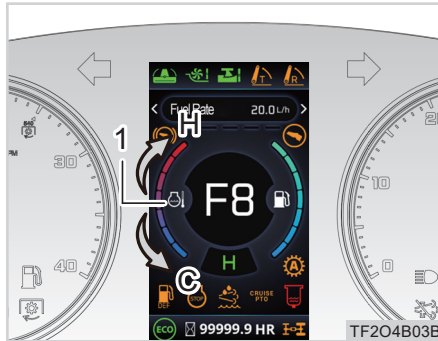
(1) Temperaturanzeige für Kühlmittel C: Kalt H: Heiß
