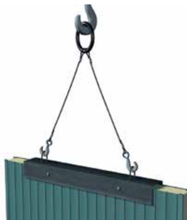
4.12.6. ábra: függőleges AWP, AWP Flex falpanel mozgatása a rövid élen U-profilal és két átmenő csavar segítségével megfogva
