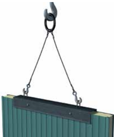
4.13.8. ábra: függőleges FH/LH/RH (< 7 000 mm) panel mozgatása a rövid élen U-profillal és két átmenő csavar segítségével megfogva
