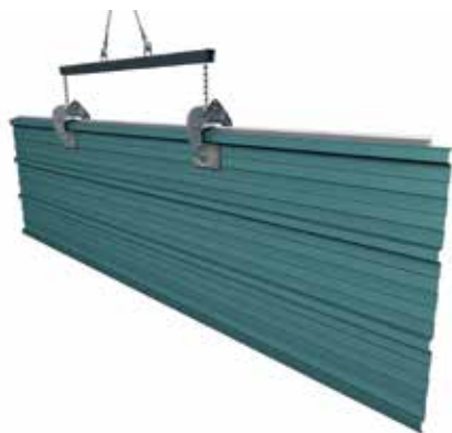
4.4.6. ábra: a tetőpanel mozgatása szerelési kiegészítő eszköz segítségével („panelcsipesz” – a panel megfogásához a trapéz bordánál)
