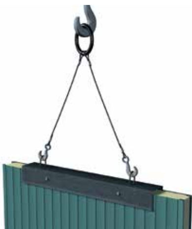
4.11.4. ábra: függőleges TF, TC (FR/RF/RB < 7 000 mm) panel mozgatása a rövid élen U-profillal és két átmenő csavar
