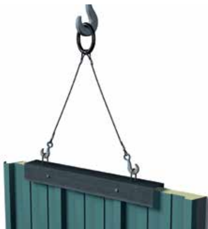
4.14.4. ábra: függőleges RW falpanel mozgatása a rövid élen U-profillal és két átmenő csavar segítségével megfogva
