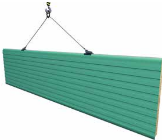
4.13.6. ábra: vízszintes FH/LH falpanel mozgatása a panel nútjában rögzíthető speciális („iron shape”) panelfogó elemmel. – Min. 2 db/panel
