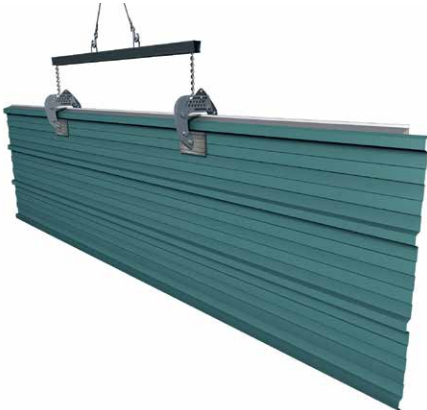
4.14.3. ábra: vízszintes RW falpanel mozgatása panelfogó segítségével (a panel megfogása a borda alatt történik)
