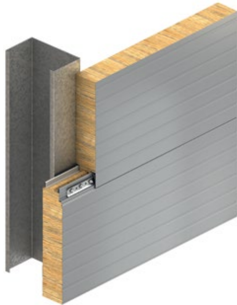
Abbildung 12: Wandelement mit Mineralwolldämmkern und mit verdeckter Befestigung mit Lastverteilerplatte und zwei Befestigern
