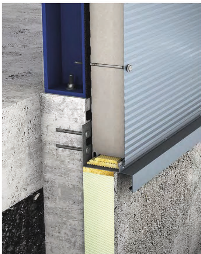
Sokl – podlaha vysoko nad úrovní UT
