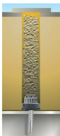
Obr. 79 – Var. XM/XG (příp. také XD) – krátký šroub pro kotvení za spodní plech panelu
