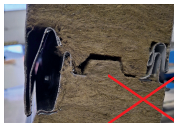
Obr. 39 – kotvení bez použití dlouhé roznášecí podložky
