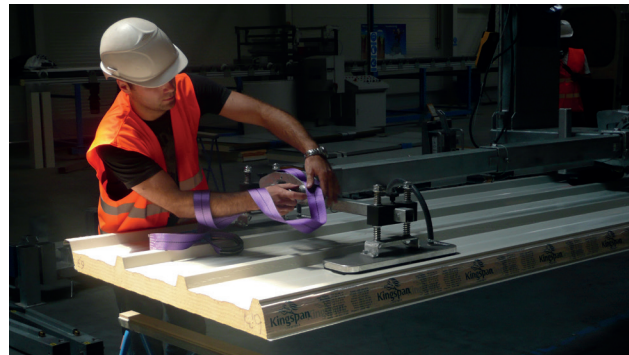
Малюнок 22. Перевернута на колони сендвіч-панель.
