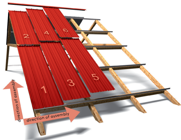
Малюнок 51. Напрямок і порядок складання панелей даху.
