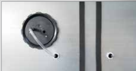
Manometerverschlauchung innerhalb der Türe
