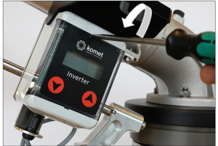
Deckel des Timers mit einem Schraubenzieher durch DREHEN des Schraubenziehers entriegeln und abnehmen.
