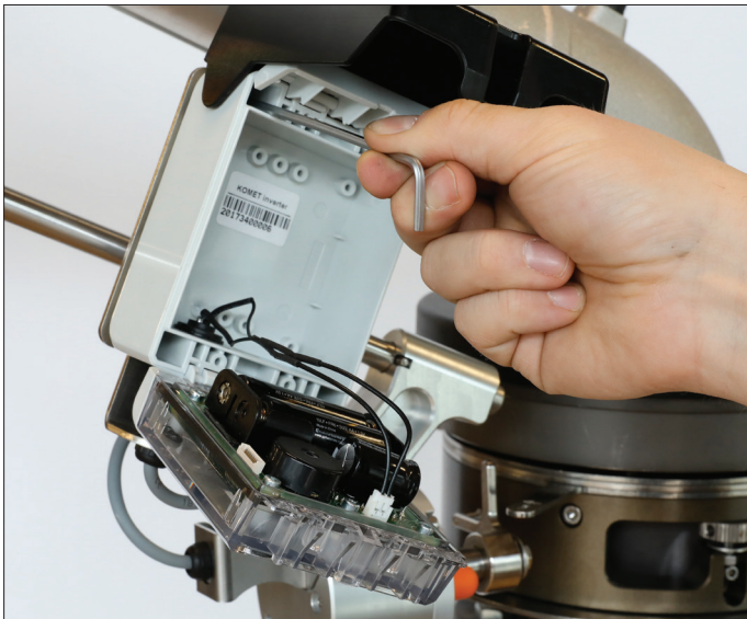
Den Timer mit den 4 mitgelieferten Inbus-Schrauben (M4 x 12) so montieren, dass der Stecker nach unten zeigt.
