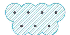
Solid-set system with jet-breaker Instalaciones fijas con rompe-chorro
