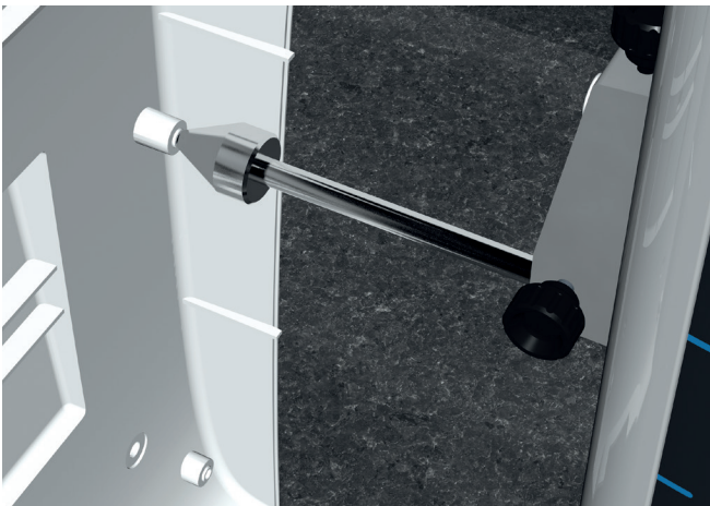
Messung des Achsabstands an einem elektronischen Plastikgehäuse
