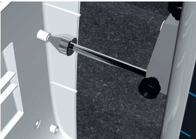
Mesure d'entraxe sur une coque plastique de boîtier électronique
