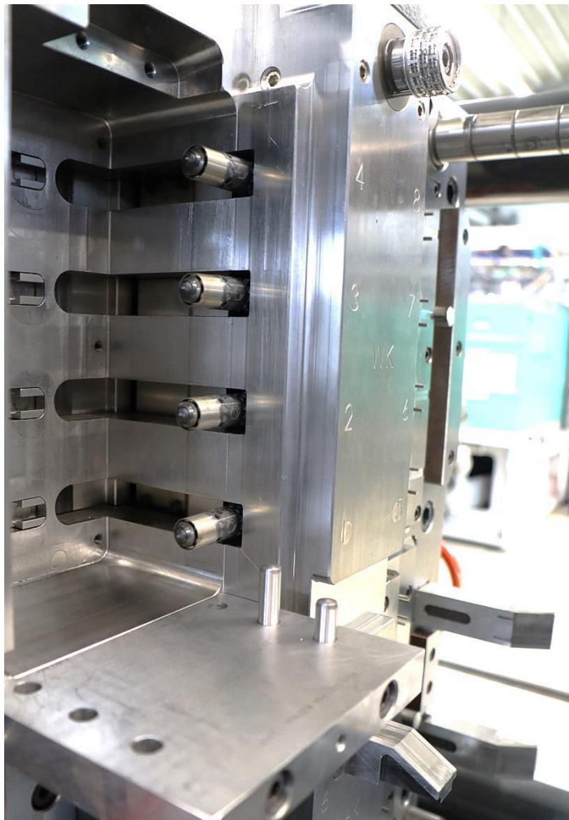
Teilansicht der Düsenseite ohne düsenseitigem Formeinsatz. (Foto: Witosa)
