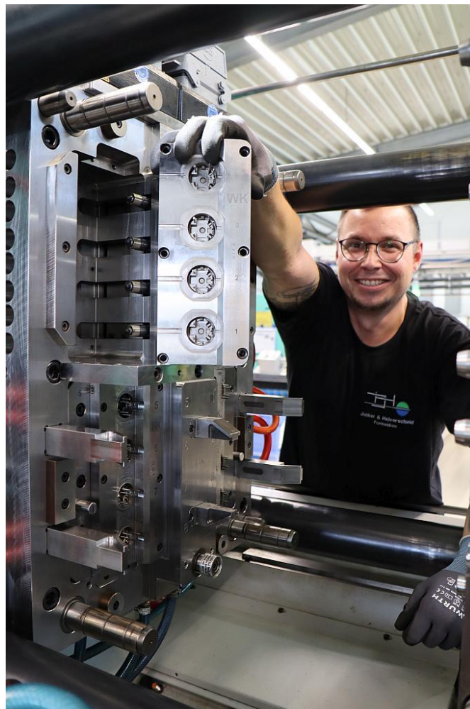
Werkzeugmachermeister Oliver Feldmann von JuHa mit ausgebautem düsenseitigen Formeinsatz. (Foto: Witosa)
