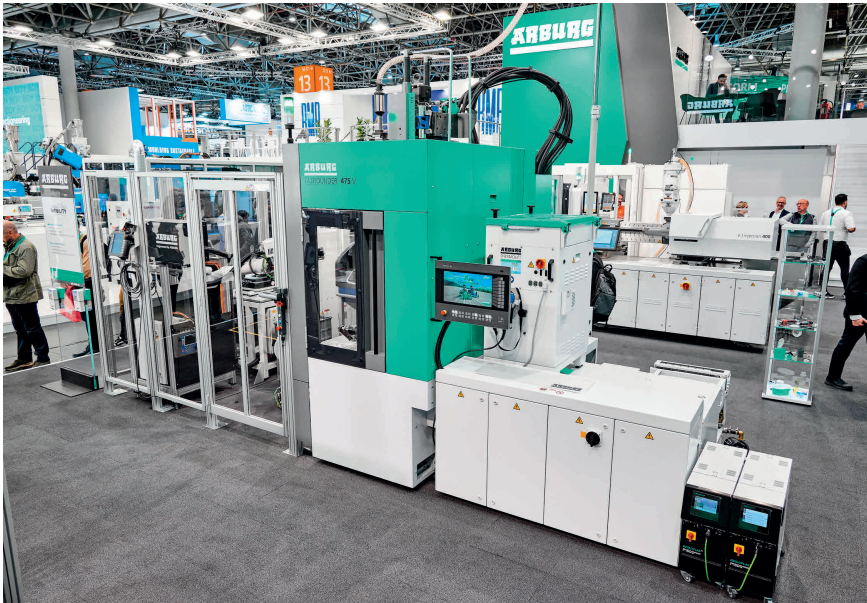
Bild 1. Eine Fertigungszelle rund um die Vertikalmaschine Allrounder 475V produzierte Funkschlüssel-Cover mit dem IMD-Verfahren, inklusive Nachbearbeitung und Kennzeichnung. © Arburg
