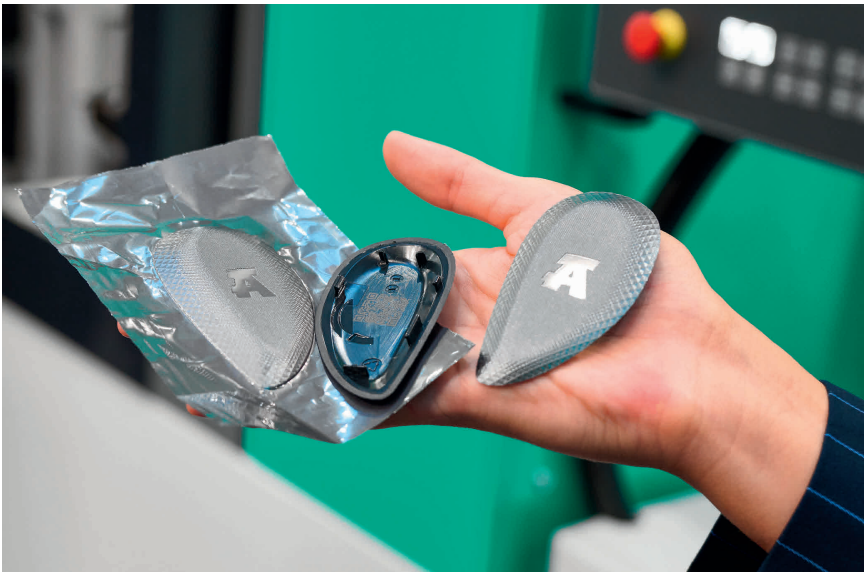
Die hochwertige Oberfläche des Covers entsteht mithilfe der IMD-Folientechnik und eines strukturierten Werkzeugeinsatzes. Das Formteil wird zuletzt mit einem QR-Code versehen. © Arburg
