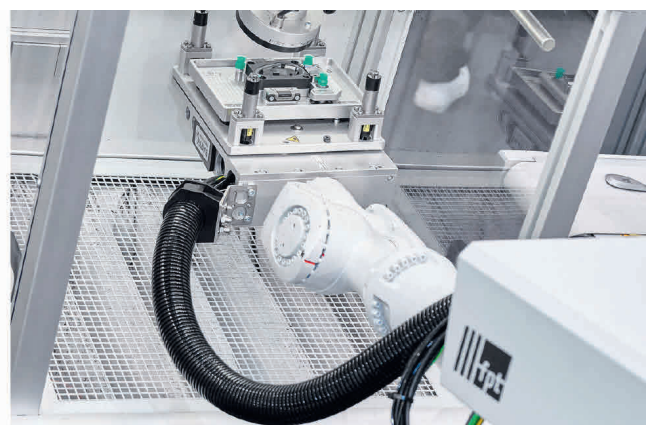
Bild 2. Im Werkzeug (links) wird die Dekorfolie mit einem PC+ABS-Rezyklat hinterspritzt. Das rechteckig ausgestanzte Spritzteil samt Folie wird dann in einer nachfolgenden Station in die passende Endkontur gefräst. Rechts: Das ausgefräste Bauteil befindet sich – auf einer Vorrichtung des Greifers verbleibend – in der Reinigungsstation. Von oben werden anhaftende Späne vom vorherigen Fräsvorgang abgeblasen. © Arburg
