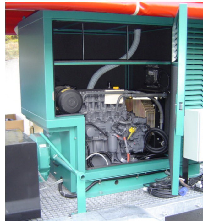
Schallgedämpfter Motor (Deutz) max. 80 dB(A)
