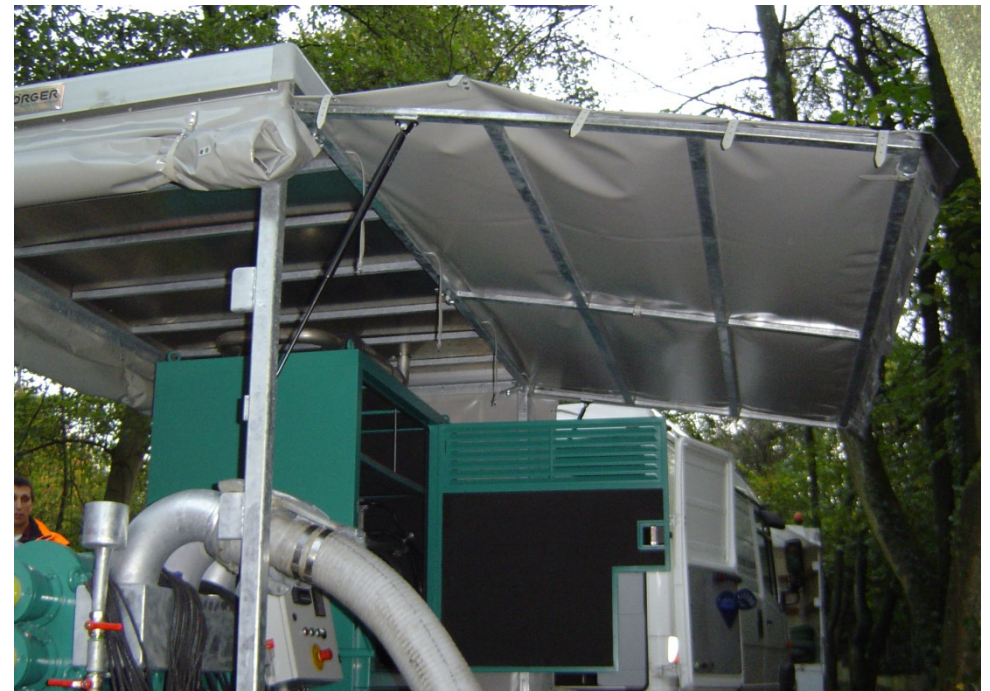
Aluminiumdach mit aufstellbaren Seitenwänden als Regenunterstand
