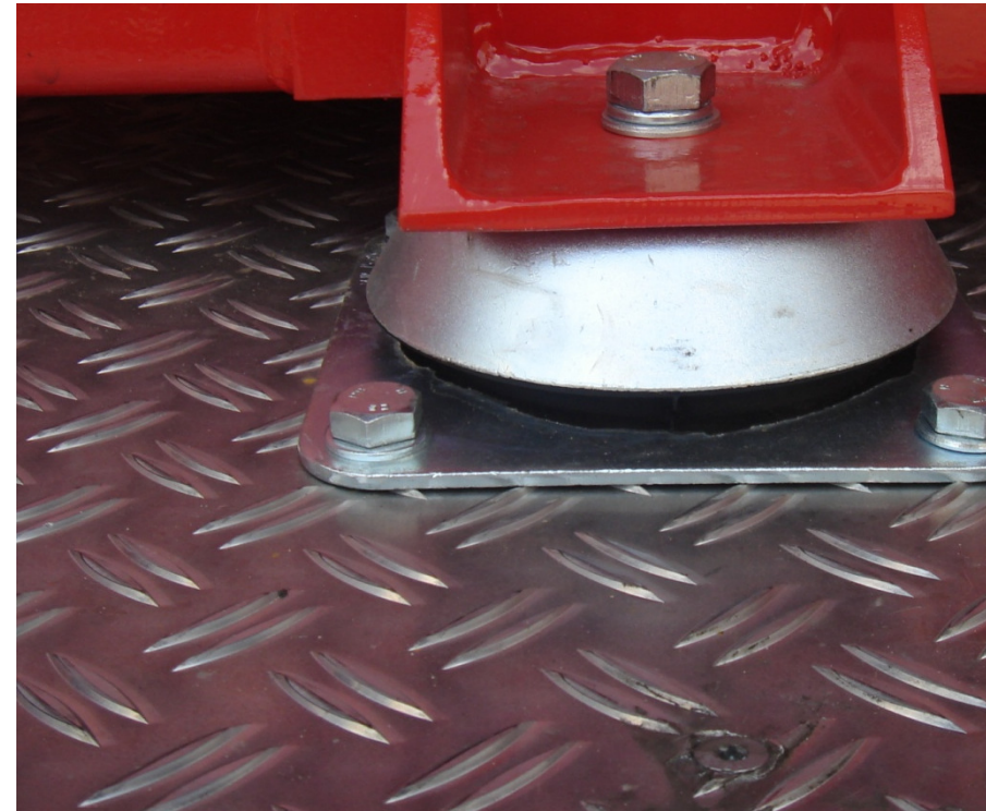
Rutschfestes Alu-Riffelblech auf Siebdruckplatte
