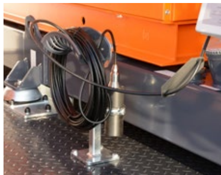
Automatikbetrieb über Höhenstandsonde
