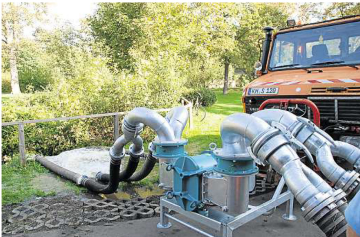
Der Unimog des städtischen Bauhofs trägt die neuen Pumpen nicht nur, er treibt sie auch an – eine preiswerte Konstruktion.
