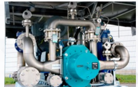
Variodeckel als mechanischer Überdruckschutz
