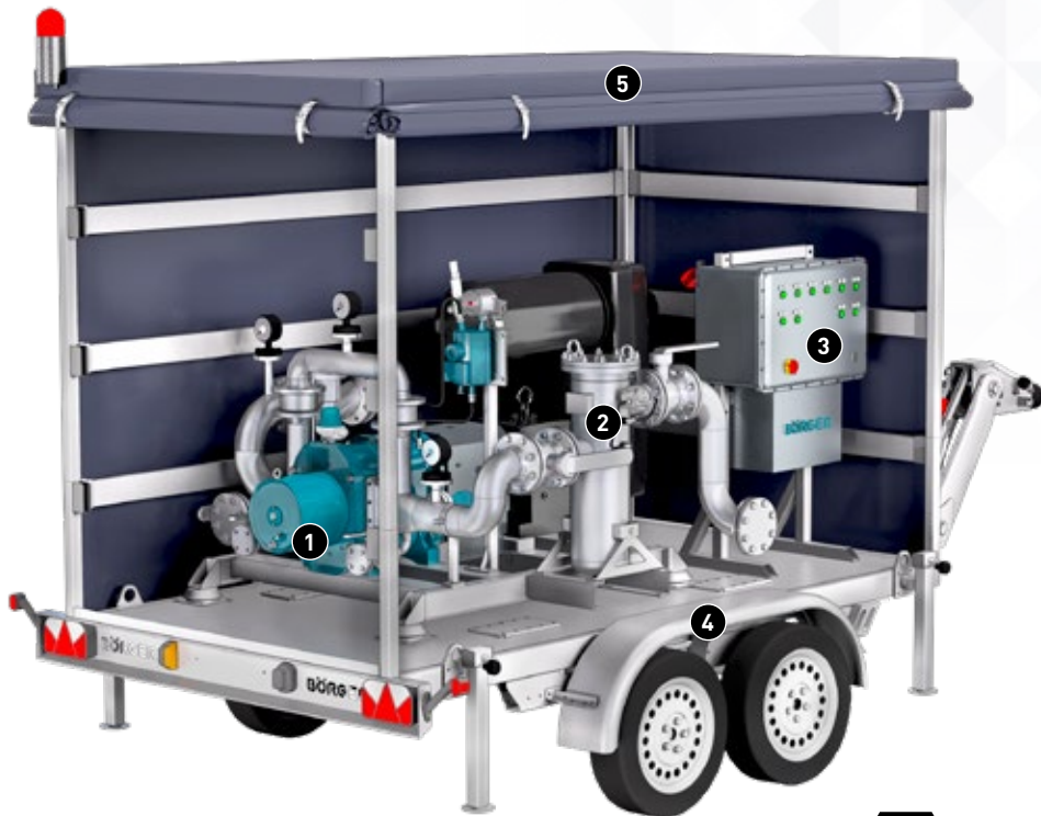
Variodeckel als mechanischer Überdruckschutz
