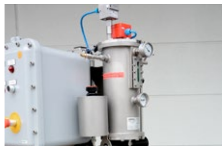
TS-Behälter mit Füllstandüberwachung, Druckabsicherung, Umwälzpumpe und Temperaturüberwachung des Sperrmediums
